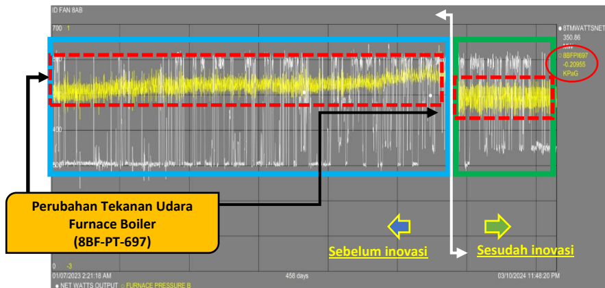
Gambar 10. Kondisi perubahan tekanan udara furnace boiler sebelum dan sesudah program inovasi dari data software PI.
