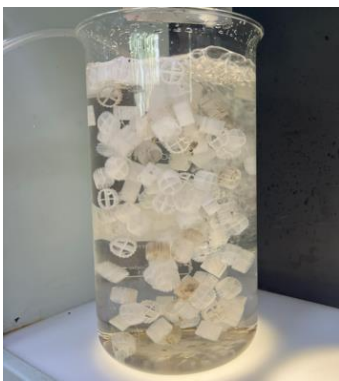
Gambar 5. Simulasi Media Packing MBBR tersuspensi pada Aeration Chamber
