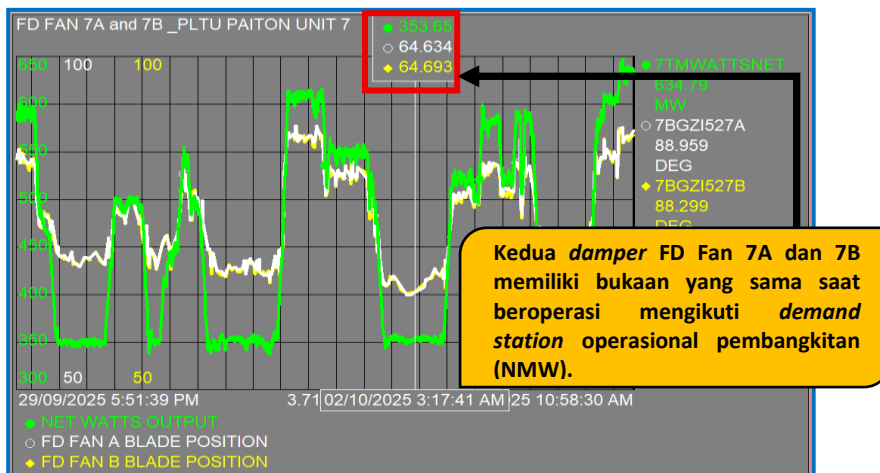
Gambar 12. Gerakan Penutup Udara Mengikuti Kebutuhan Beban
