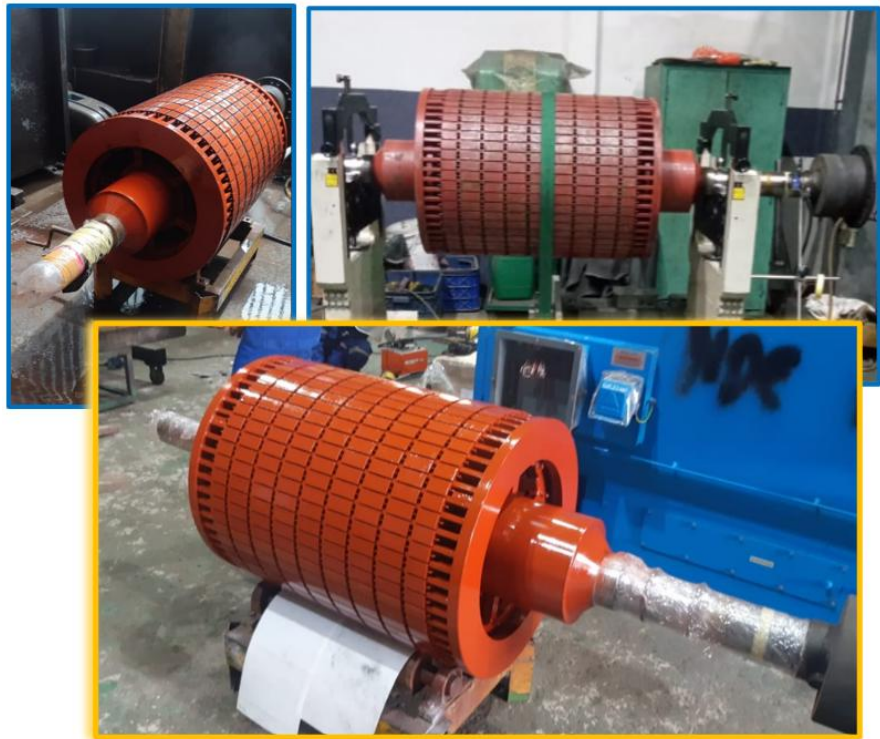
Gambar 16. Pemeriksaan Bagian Motor
